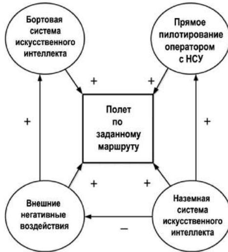
Рис. 2. Нечеткая когнитивная карта управления БВС в благоприятных внешних условиях (рисунок автора)
