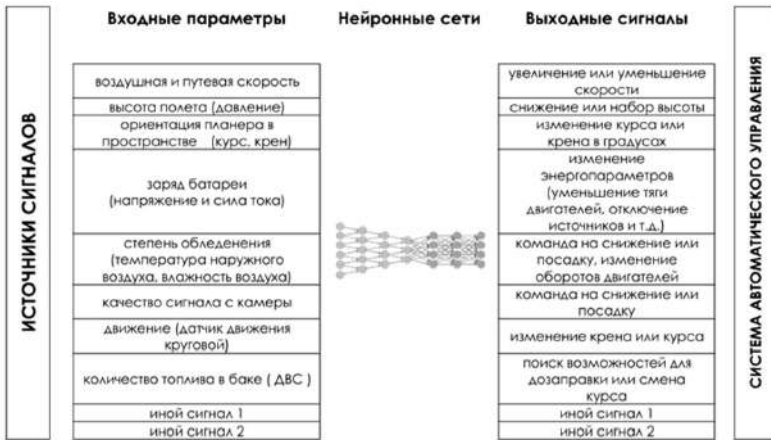
Рис. 4. Соответствие входных и выходных сигналов искусственной бортовой нейросети БВС (рисунок автора)
