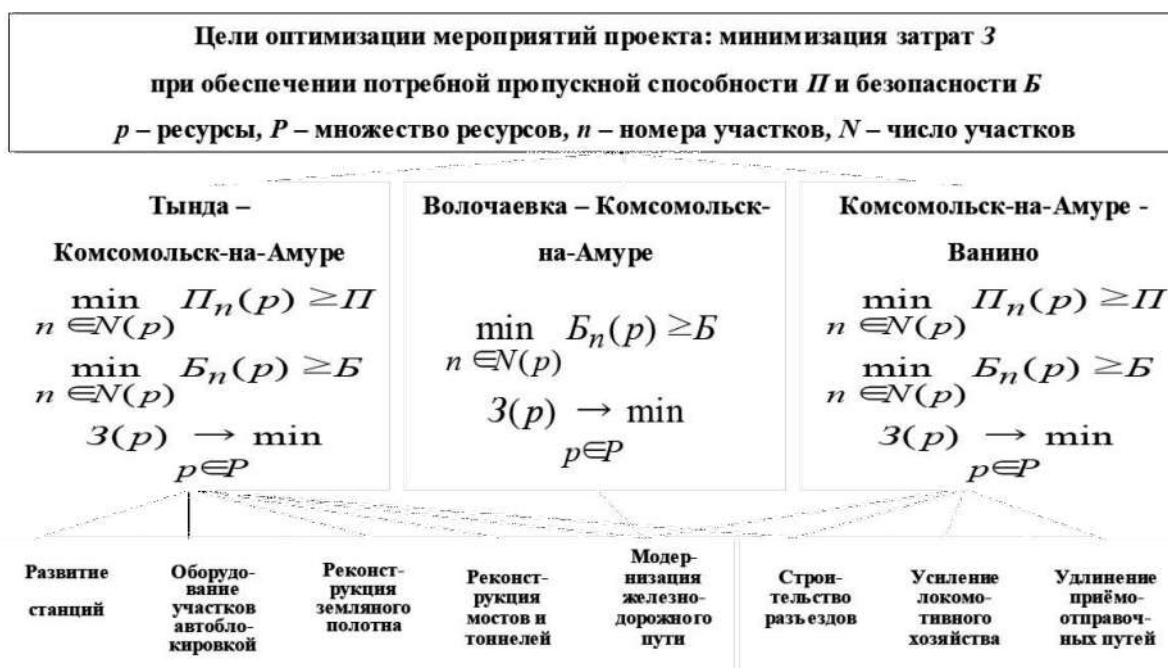
Рис. 7. Модели оптимизации мероприятий проекта реконструкции Восточного полигона БАМ
