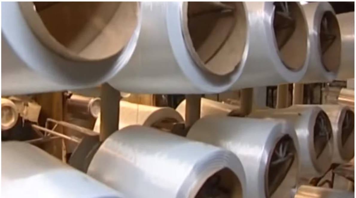
Фото 8 – Готовая продукция, намотанная на бобины (прямой ровинг и комплексная нить).
