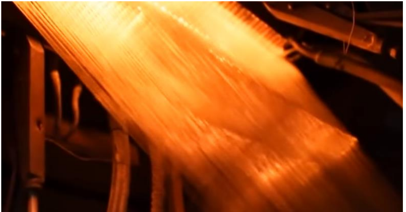
Фото 6 – Вытягивание волокон внутри наматывающего аппарата
