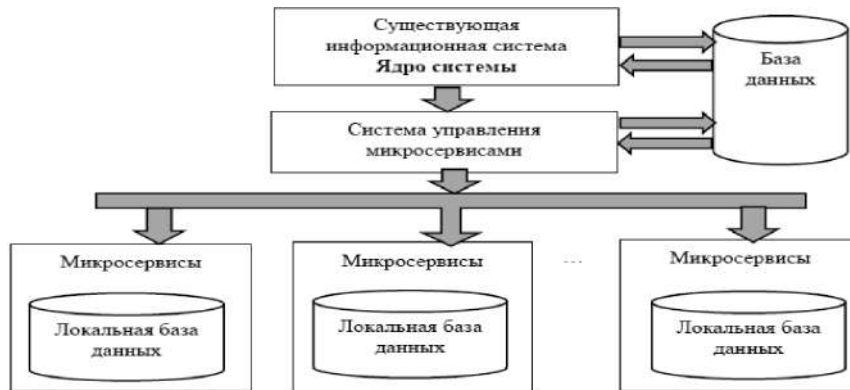
Рис. 1. Обобщенная схема микросервисной архитектуры Интернет-банка
